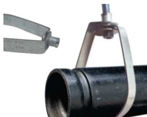
SOPORTE TIPO PERA UL/FM, VARILLA ROSCADA, CHAZO, TUERCA Y ARANDELA
